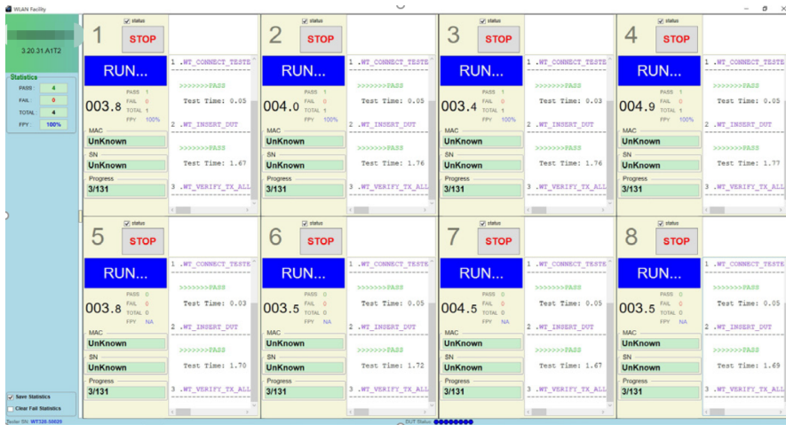
图 16 面向SLE模块生产测试的自动化测试程序示意图
