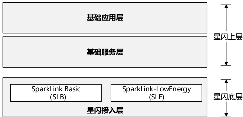
图 1 星闪无线通信系统
