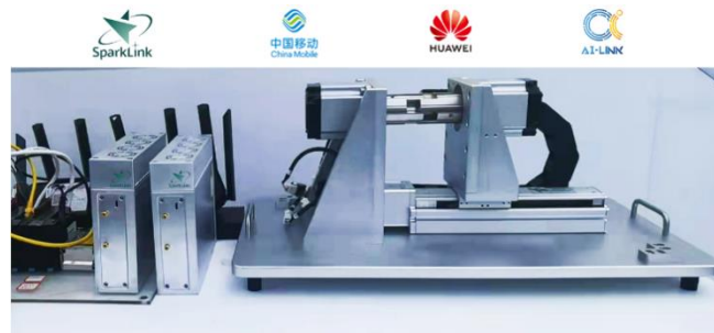
图 20 基于5G+星闪融合技术的电机同步控制原型系统
